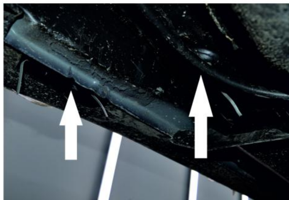
Рис. 2 - Установка фиксируемых гаек в задней части автомобиля
